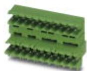
Carcasa base placa de circuito impreso, corriente nominal: 10 A, tensión de dimensionamiento (III/2): 320 V, número de polos: 6, paso: 5,08 mm, color: verde, superficie contactos: Estaño, montaje: Soldadura por ola, ¡El artículo puede alinearse con distintos números de polos! En el caso de una combinación con partes enchufables MVSTB o FKCV, debe utilizarse un conector MVSTBW (o FKCVW) y un conector MVSTBR (o FKCVR), respectivamente. ¡Una combinación con partes enchufables TMSTBP no es posible!
