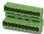
Carcasa base placa de circuito impreso, corriente nominal: 10 A, tensión de dimensionamiento (III/2): 320 V, número de polos: 6, paso: 5,08 mm, color: verde, superficie contactos: Estaño, montaje: Soldadura por ola, ¡El artículo puede alinearse con distintos números de polos! En el caso de una combinación con partes enchufables MVSTB o FKCV, debe utilizarse un conector MVSTBW (o FKCVW) y un conector MVSTBR (o FKCVR), respectivamente. ¡Una combinación con partes enchufables TMSTBP no es posible!
