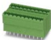
Carcasa base placa de circuito impreso, corriente nominal: 10 A, tensión de dimensionamiento (III/2): 320 V, número de polos: 6, paso: 5,08 mm, color: verde, superficie contactos: Estaño, montaje: Soldadura por ola, En el caso de una combinación con partes enchufables MVSTB o FKCV, debe utilizarse un conector MVSTBW (o FKCVW) y un conector MVSTBR (o FKCVR), respectivamente. ¡Una combinación con partes enchufables TMSTBP no es posible!
