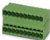
Carcasa base placa de circuito impreso, corriente nominal: 10 A, tensión de dimensionamiento (III/2): 320 V, número de polos: 6, paso: 5,08 mm, color: verde, superficie contactos: Estaño, montaje: Soldadura por ola, En el caso de una combinación con partes enchufables MVSTB o FKCV, debe utilizarse un conector MVSTBW (o FKCVW) y un conector MVSTBR (o FKCVR), respectivamente. ¡Una combinación con partes enchufables TMSTBP no es posible!
