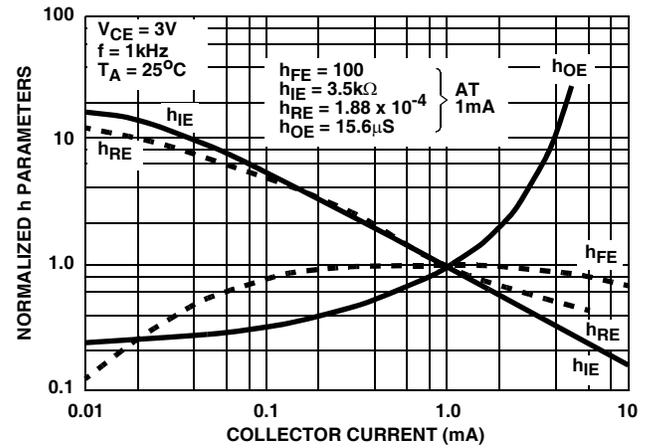
FIGURE 6. NORMALIZED  $h_{FE}$ ,  $h_{IE}$ ,  $h_{RE}$ ,  $h_{OE}$  vs  $I_C$
